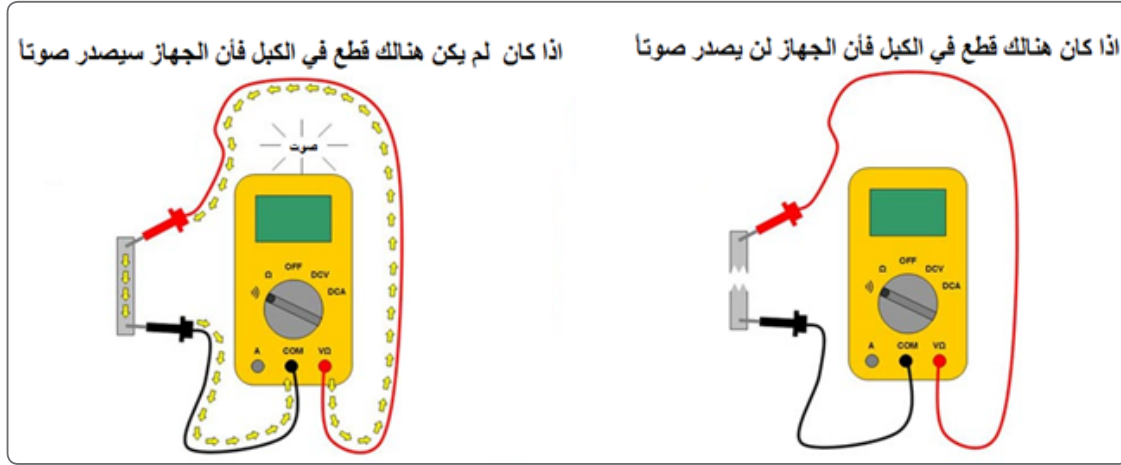
الشكل (١١): فحص الاستمرارية في جهاز الملتيميتر.
