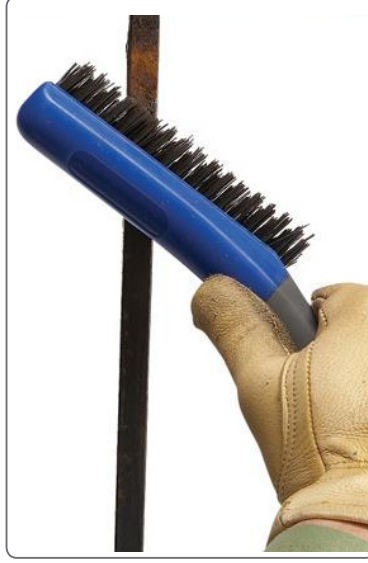
الشكل (٢١): كشط الصدأ باستخدام فرشاة سلك معدنية.
