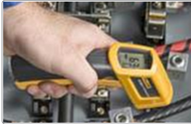
الشكل (٧): جهاز الليزر الحراري لقياس درجة الحرارة.
