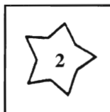
الشكل (٩): فولتية فحص الجهاز (٢٠٠٠ فولت).
