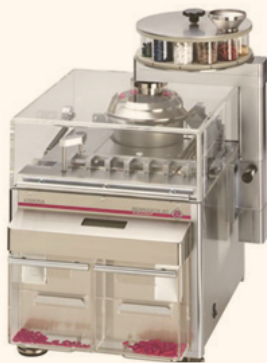
الشكل ٧.٣ معدات القياس الآلية - الوزن، السماكة، والصلابة
