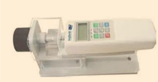
الشكل ٩.٣ جهاز فحص سماكة الأقرص الرقمي المنقل
