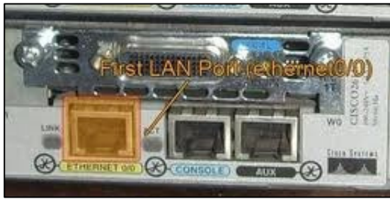
شكل (٩٤): منفذ توصيل الموجه مع جهاز التبديل
