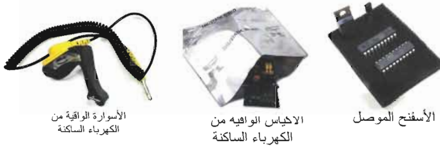
الشكل(51): الإجراءات للوقاية من أخطار تفريغ شحنات الكهرباء الساكنة.
