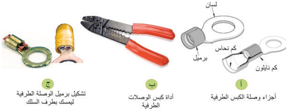
الشكل (١٨): أجزاء وصلة الكبس الطرفية، وطريقة تركيبها على طرف السلك الكهربائي.
