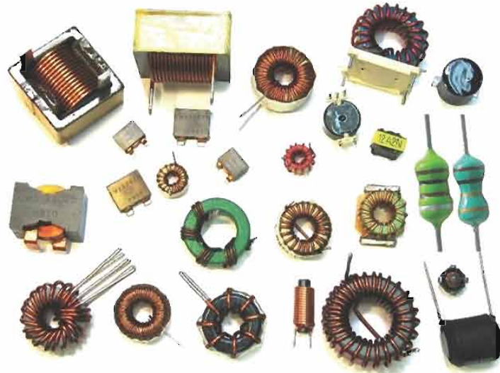
الشكل (69): الأشكال الشائعة للملفات المستخدمة في الدارات الإلكترونية.
