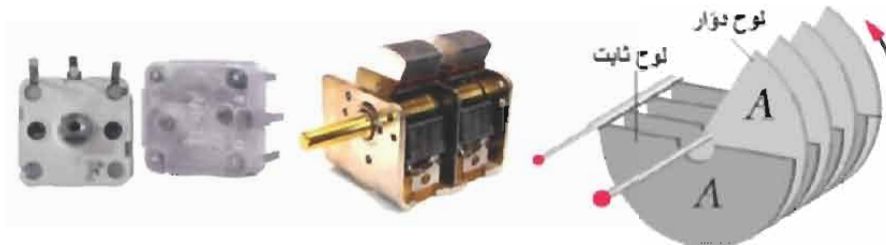
(أ) تركيب المواسع الهوائي المتغير القيمة (ب) الأشكال الشائعة للمواسع المتغير الشكل (65): المواسع متغيرة القيمة.
