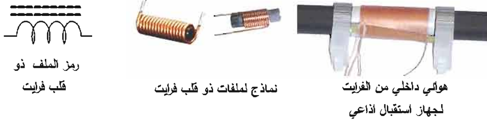
الشكل (73) نماذج من الملفات ذات قلب الفيريت ورمز الملف ذو قلب الفيريت.
