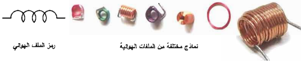
الشكل (71) نماذج من الملفات الهوائية ورمز الملف الهوائي.
