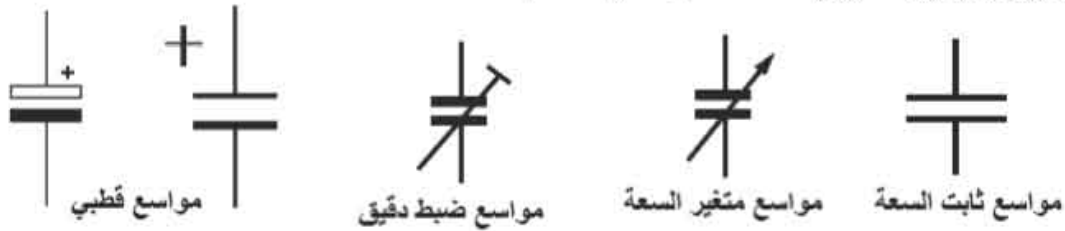
الشكل (58) رموز الأنواع المختلفة من المواسعات.
