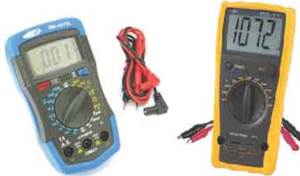
(أ) جهاز قياس السعة والمحاثة (ب) جهاز قياس المقاومة والسعة والمحاثة الشكل (76): أجهزة رقمية لقياس الحثية.
