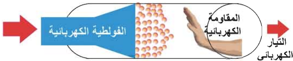
الشكل (9): توضيح مفهوم المقاومة الكهربائية.
