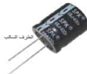
الشكل (63): طريقة الاستدلال على القطب الموجب في المواسع الكيميائي.
