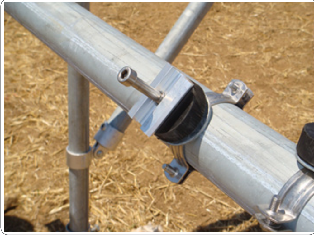
الشكل (١٦): تثبيت الجسور الرئيسية على أساس النظام.
