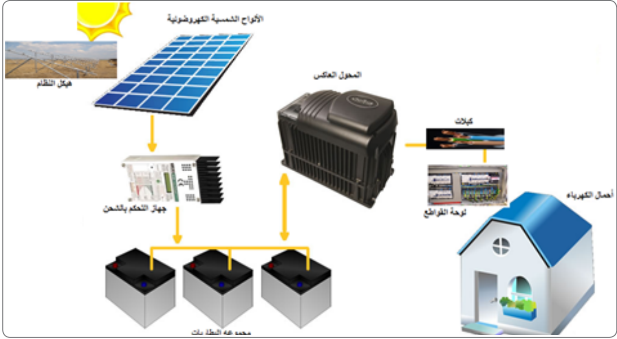
الشكل (١٦): مكونات النظام الشمسي الكهروضوئي المستقل.
