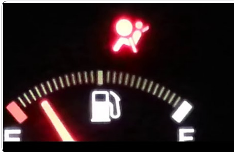
الشكل (٣): مصباح التحذير للوسادة الهوائية.
