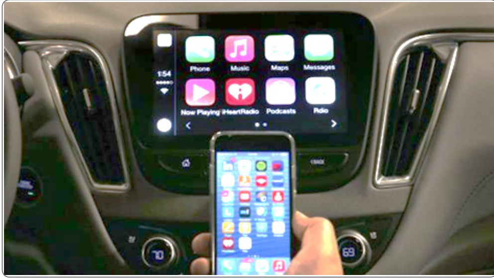
الشكل (1): نظام كاربلدي أبل لإدارة وسائل الترفيه بالسيارة عبر الهاتف الذكي.
