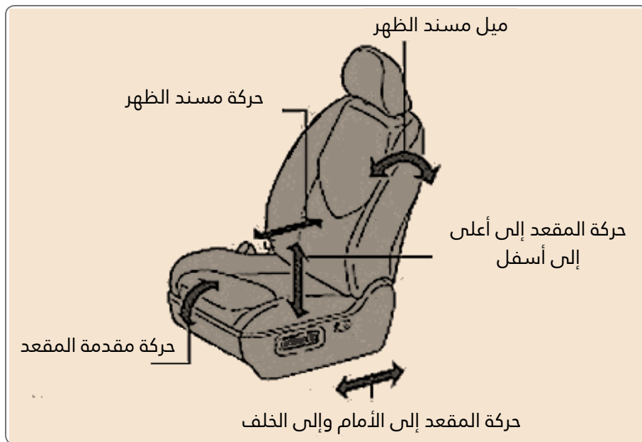
الشكل (٥): حركات المقعد المتحكم به كهربائياً.
