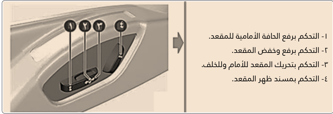
الشكل (٦): مفاتيح التحكم بالمقعد الكهربائي.
