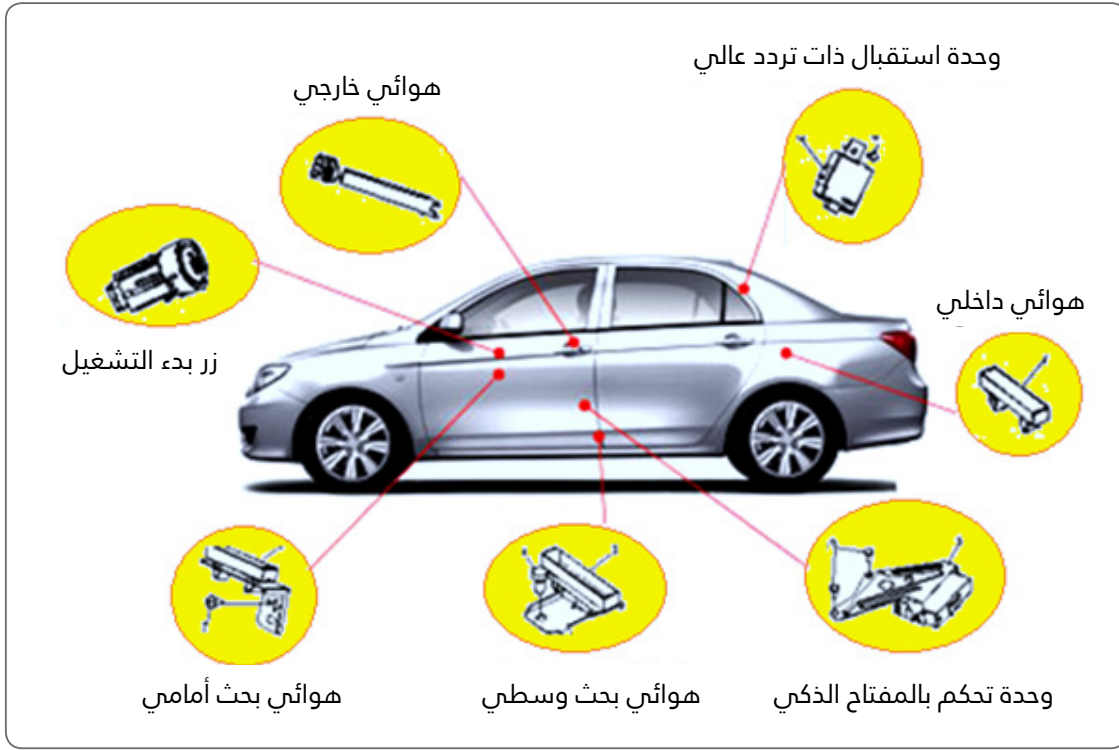
الشكل (١٩): مكونات نظام المفتاح الذكي.
