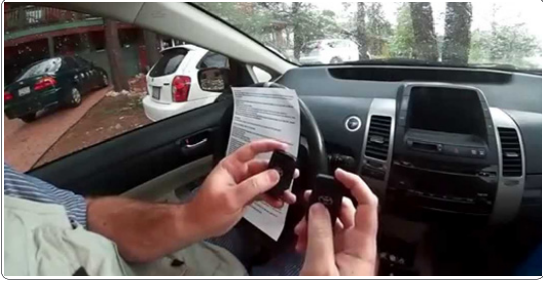
الشكل (٢٣): برمجة المففتاح الذكي من داخل المركبة.
