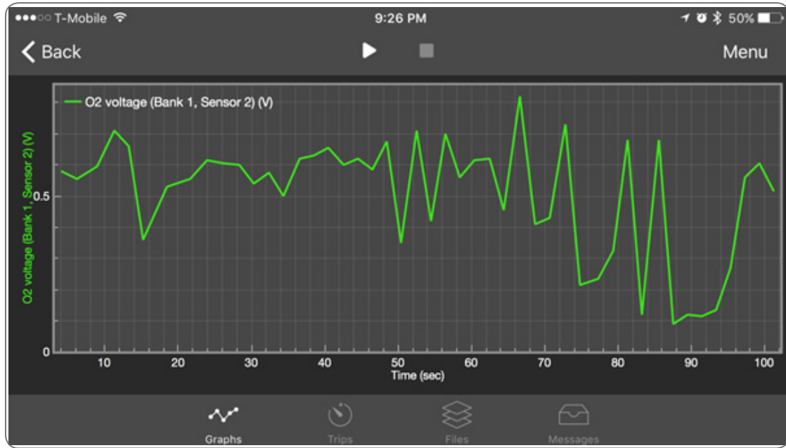
الشكل (١٣): إشارة حساس الأوكسجين التالف.
