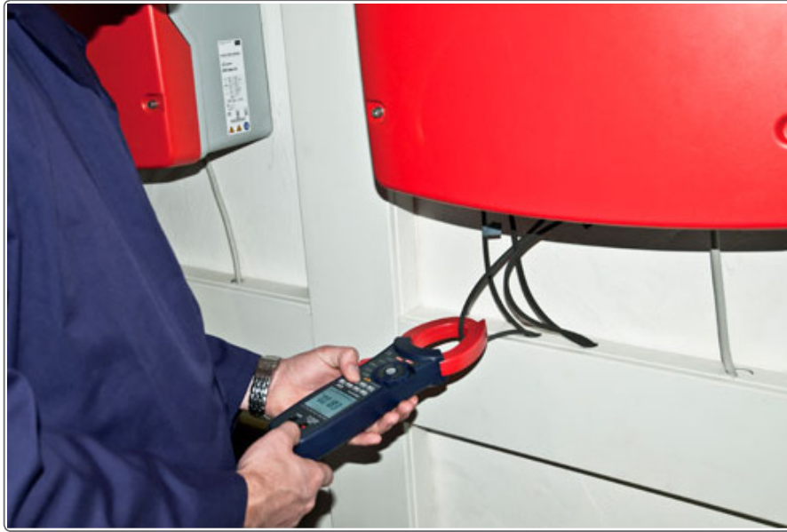
الشكل (٣٦): استخدام الملتيميتر في قياس شدة التيار للأنظمة الشمسيّة الكهروضوئيّة.
