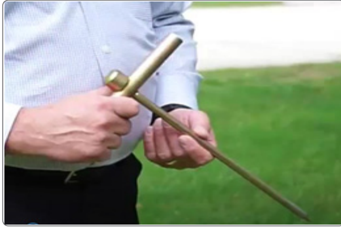
الشكل (١٨): غرز القطب الخاص بالتيار في الأرض.
