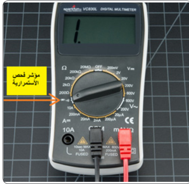
الشكل (٤): مؤشر فحص الاستمرارية في جهاز الملتيميتر.
