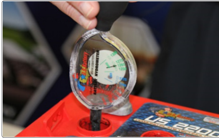
الشكل (٣٠): فحص الوزن النوعي في لسائل المركم باستخدام الهيدروميتر.
