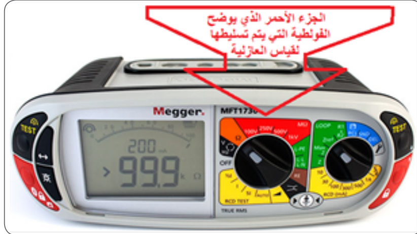
الشكل (٣): الجزء المخصص في جهاز فحص العازلية لتسليط الفولطية العالية.
