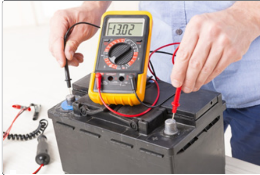
(الشكل ٢٩): قياس إجمالي فولطية المرحم تبعاً لأوامر العمل.
