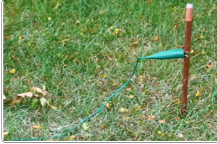
الشكل (١٧): وصل قضيب التأريض بالكبل الأخضر المتصل بجهاز فحص التأريض.
